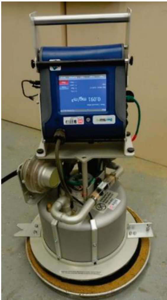
ERDC/GSL TR-21-31 FIGURE 12PI-SWERL: Montage d'essai PI-SWERL en laboratoire
